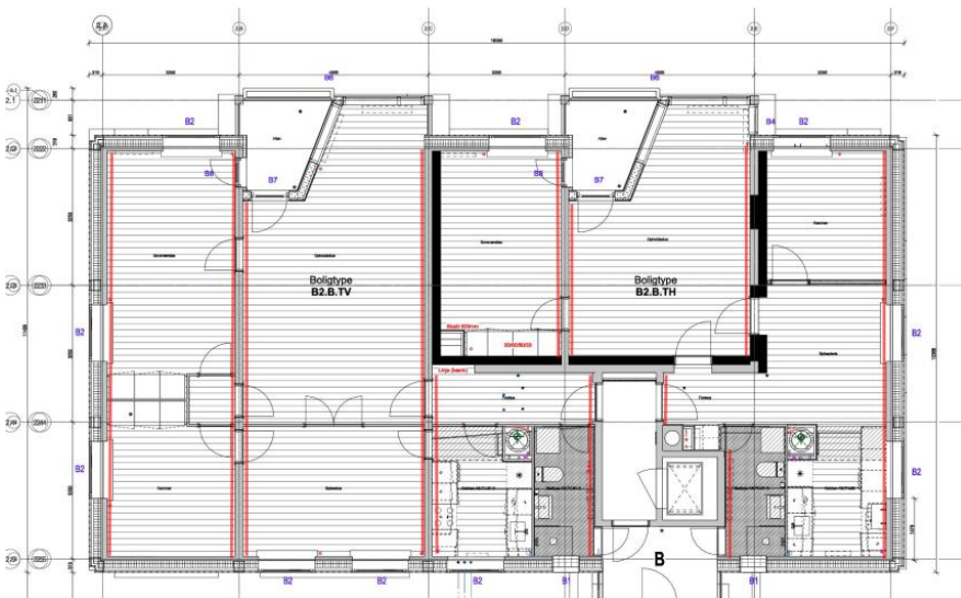
Figur 3.8, princip for placering af vinkelbeslag fra SAB 1 blok 2, vest illustreret med rød på figuren
